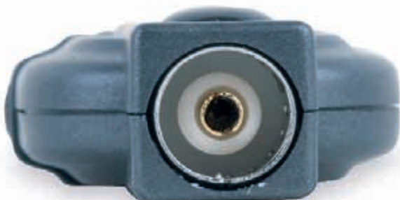
Port TV (analog) in. Satu-satunya port yang tersedia pada produk ini.
